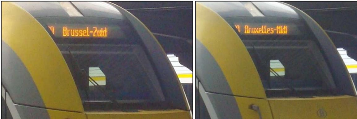
Variante 3.2.1.4: durchlaufende Anzeigen bei Platzmangel im Anzeigefeld, wird z.B. bei Cottbusverkehr für deutschsprachige Laufweginformationen eingesetzt (Fotos: Wales)
